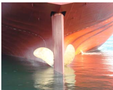
MECHA DEL TIMON INTRODUCIENDOSE EN EL BARCO POR EL ORIFICIO LLAMADO LIMERA
